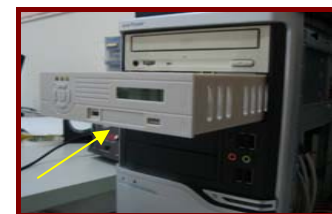
圖四 推入電腦機架中，以螺絲固定
